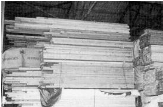
Fig. 1: Apilado incorrecto al apilar los tablones de mayor longitud sobre los más cortos
