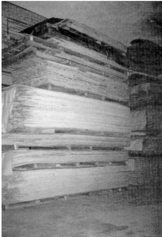
Fig. 8: Almacenamiento de chapas en palets
